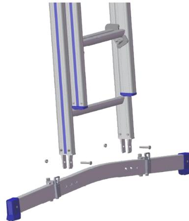
*Abbildung 5: Klapptraverse montieren*
