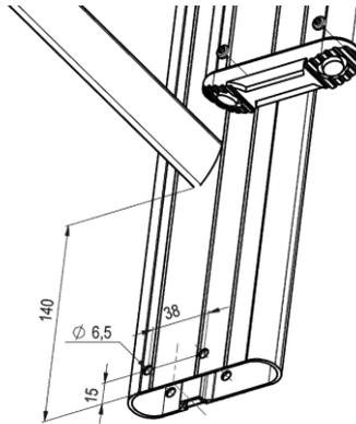
*Abbildung 2: Maße für Zuschnitt und Bohrungen (mm)*
