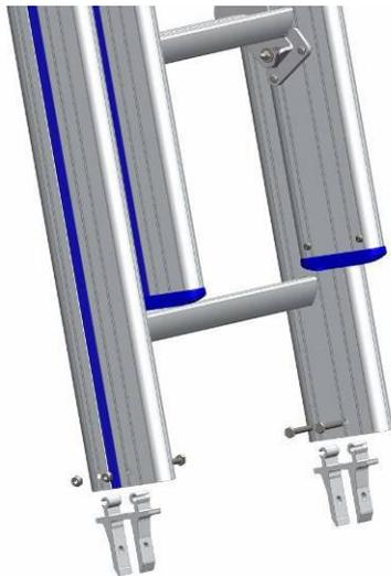
*Abbildung 4: Traversenbefestigungen montieren*
