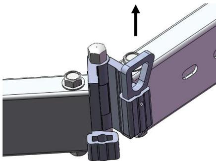
Abbildung 9: Traversensicherung lösen
